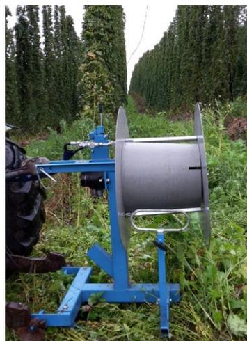
Fixez les extrémités des fils d'un cadre de fil sur le tambour d'enroulement. Passez d'abord toutefois l'ensemble des extrémités regroupées dans le guide-fil, avant de les insérer dans la fente du tambour d'enroulement ou de les fixer à la barre de détente.
